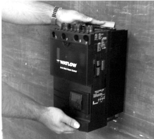
Figura 2.4 — Desmontaje del controlador.
